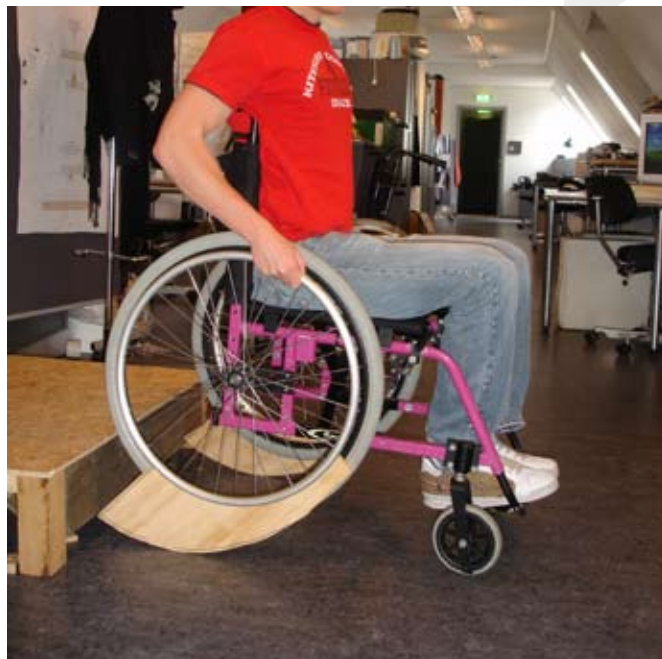
ill. 2.9.2 Forsøg med træskiver, der ændrer kørestolens hjulradius.
