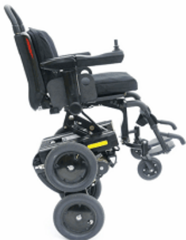
ill. 1.10.3 Ibot balancerer på to hjul vha. gyroskoper.
