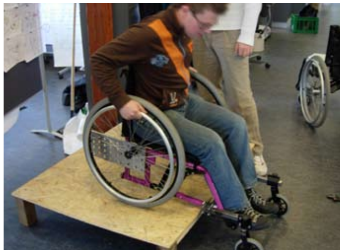
ill. 2.9.10 Flytning af baghjulet får kørestolen til at stå mere lige, når den kører op på trinnet.
