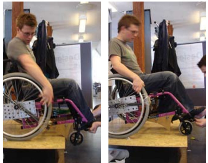
ill. 2.9.21 Glideskinne, der automatisk hiver forhjulene med op, når brugeren kører baglæns.
