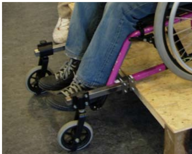
ill. 2.9.13 Udskydning af forhjulene gør kørestolen længere, så balancen forbedres.
