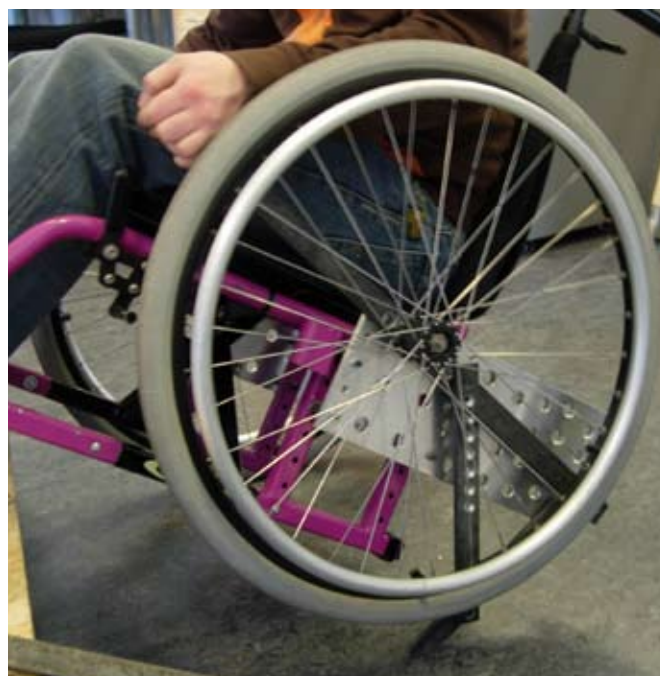
ill. 2.8.9 En videreudvikling af skubbearmen, der gør brug af vægtstangsprincippet.
