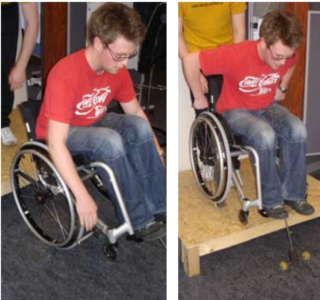
ill. 2.9.9 Test af løftestangsprincippet i kombination med ekstra forhjul.
