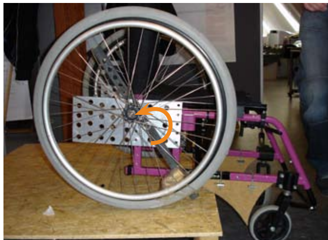
ill. 2.9.9 Flytning af baghjulet kombineret med løftestangen.
