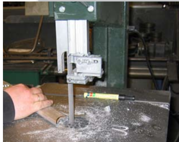
3.12.10 Profilerene skæres til, så håndtaget kan svejses på.
