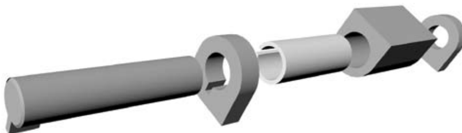
ill. 6.9.6 Nylonleje. Set fra venstre: akse, bagpladebeslag, nylonrør, rygsøjlebeslag og bagpladebeslag
